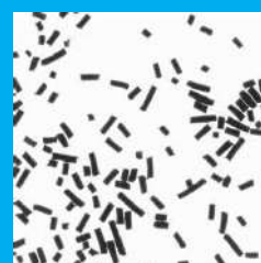
バックライト光源の 使用によるサンプルの セグメント分け
